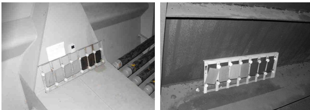
Obrázek 4 – Měření klimatických údajů a expozice vzorků v komorách
