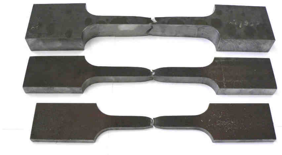
Obrázek 5: Ploché tahové zkoušky tloušťek 10, 20 a 35 mm po přetržení
