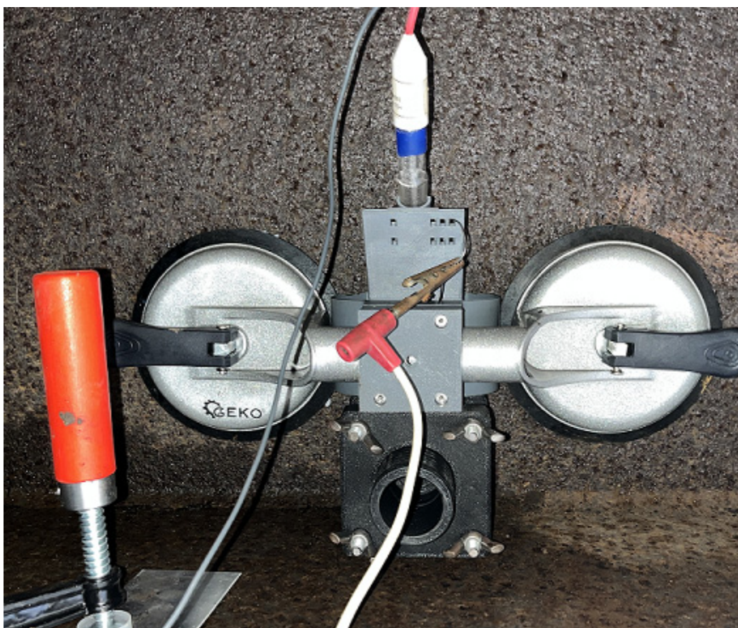
Obr. FV 22. Měření EIS charakteristik (řádového specifického odporu) na OP 1 (stojina/stěna) – první nosník (pravá strana) – ŽALMANOV
