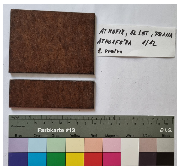
Obr. FV 9. Příklad vizuálního hodnocení (obsahuje kolorimetrické měřítko) stavu patiny na vzorku odebraného kupónu ke korelaci se vstupními hodnotami EIS charakteristik
