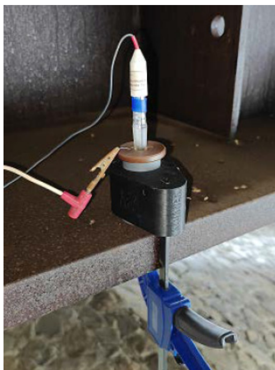
Obr. FV 18. Měření EIS charakteristik (řádového specifického odporu) na OP 1 (horní povrch dolní pásnice) – pravý nosník (pravá strana) – OSTRAVA – SO 2
