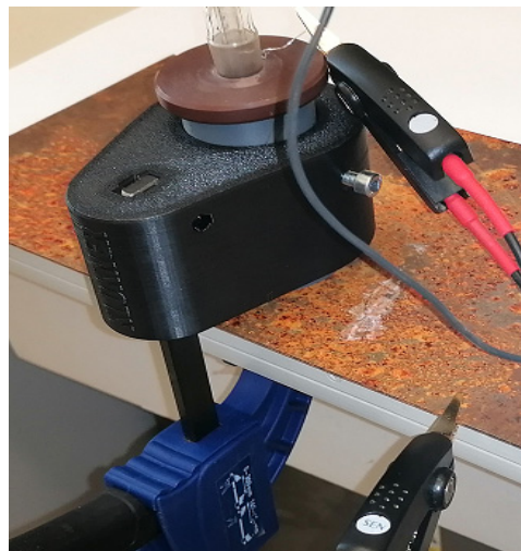
Obr. FV 2. Realizace této cely s přesností 0,1 mm dle schématu prostřednictvím 3D tisku – aplikace na horní povrch dolní pásnice – víčko bylo realizováno z polyakrylátu a tělo z PP
